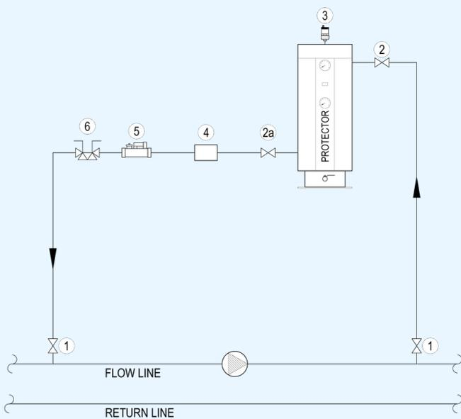
Protector er en selvregulerende vannbehandler som holder anlegget rent og fritt for korrosjon. På sikt vil dette gi lengre levetid og best mulig virkningsrad, og lave drifts omkostninger.
